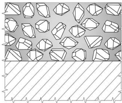
Une exécution spéciale dans le domaine des liants galvaniques consiste à apposer sur la monture une couche de revêtement abrasif de 0,65 – 1,5 mm. En termes d'enlèvement de copeaux et de performance de coupe, ce revêtement abrasif est comparable à une couche frittée en bronze.
